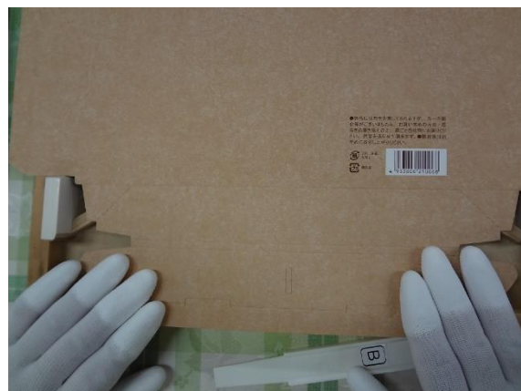
2. 治具に資材をのせて固定する
