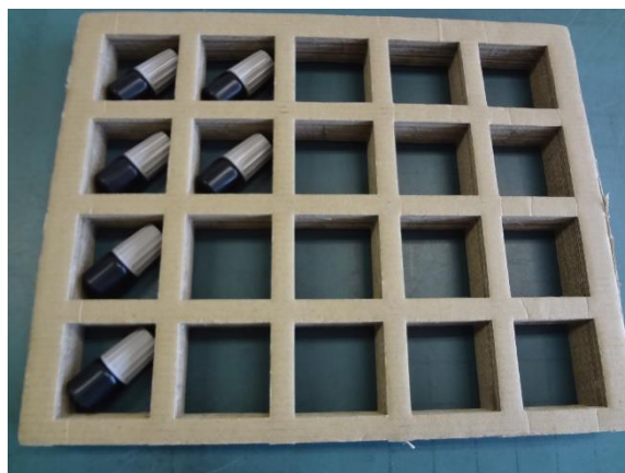
型にはめ込むだけで決められた数（20 個）がカウントできる
